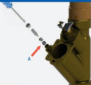
Retire o parafuso injetor com o auxílio de uma chave de fenda. Substitua a guarnição do injetor (A) pela que acompanha o kit Multi Reparos.
