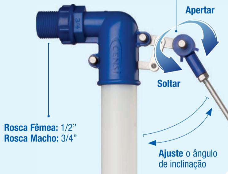
Para instalar, introduza a rosca da válvula no orifício (sem flange) de alimentação (já pronto) e rosqueie pela parte externa a contra-porca que acompanha a válvula. A boia deve ser acoplada na haste da válvula.
