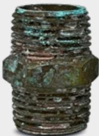
Peça oxidada sem decapagem e passivação
