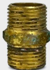
Peça oxidada com decapagem e passivação
